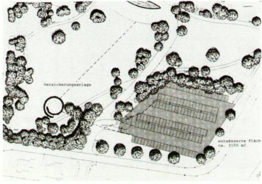
gestalterischen Schwerpunkt. Es wurde mit Betonmauern ein begehbares Becken von 1,5 Meter Tiefe erstellt (Durchmesser etwa 12 Meter). Die geschwungene Form wird an der Maueroberkante durch eine Buchshecke betont. Der Boden des Beckens wurde gemäss den kantonalen Vorschriften als humusierte Mulde ausgebildet. Das Wasser versickert über die belebte Bodenschicht, diese ist als Rasen ausgebildet.
