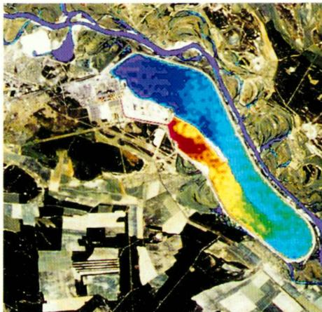
Umweltmonitoring, demonstriert am Beispiel Tschernobyl. Dargestellt sind Kraftwerksteck (oben) und Kühlwassersee (unten) sowohl für einen Zeitpunkt vor (links) und nach dem Unfall (rechts) als farbkodierte TM-Thermaldaten.
