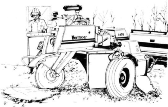
Die Baumstrunkfräsen. Entfernen unansehnliche, störende Strünke minutenschnell.
