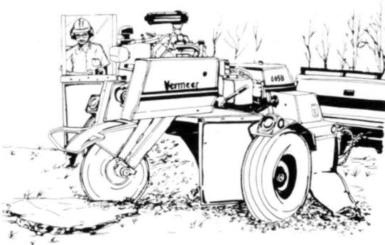
Die Baumstrunkfräsen. Entfernen unansehnliche, störende Strünke minutenschnell.
