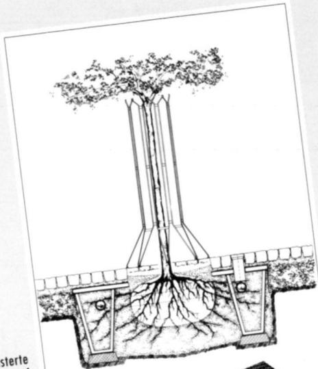
Gepflasterte Baumscheiben auf einem Wurzelraum ohne Verdichtung; dies ist möglich, seit es den IFF Unterflurbaurost gibt.
