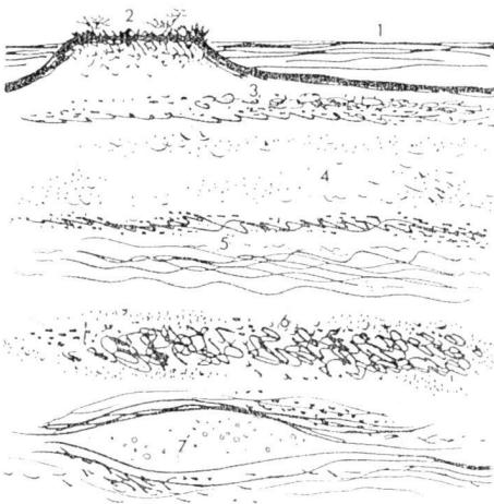
Schematischer Schnitt durch den geologischen Aufbau der Lagune: 1 Wasser, 2 Sandbänke oder flache Inseln, 3 Schwemmgrund der Lagune, bedeckt von einer Schlammsschicht, 4 Fester Grund aus einem Gemisch von Ton und Sand («caranto»), 5 Grundwasserspiegel, 6 Torfablagerungen, 7 Gaseinschlüsse.
