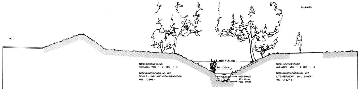
Normalprofil Typ 1: Ufersicherung mit Hochstaudensoden und Jutematten.
