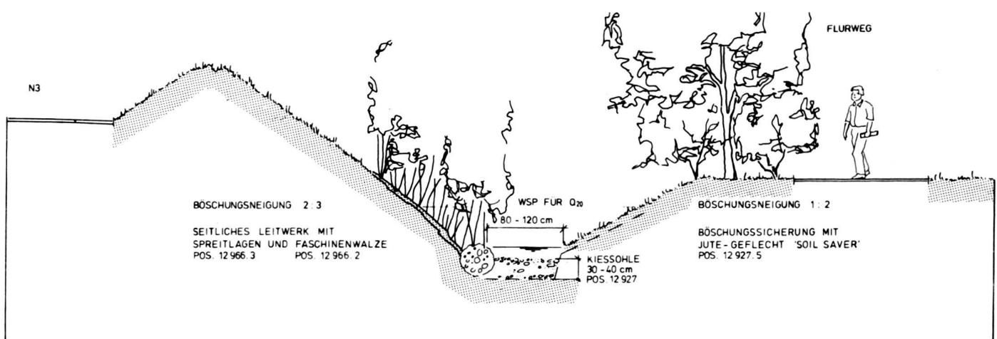
Normalprofil Typ 2: Ufersicherung mit Faschinenspreitlagen-Kombinationen und Jutematten.
