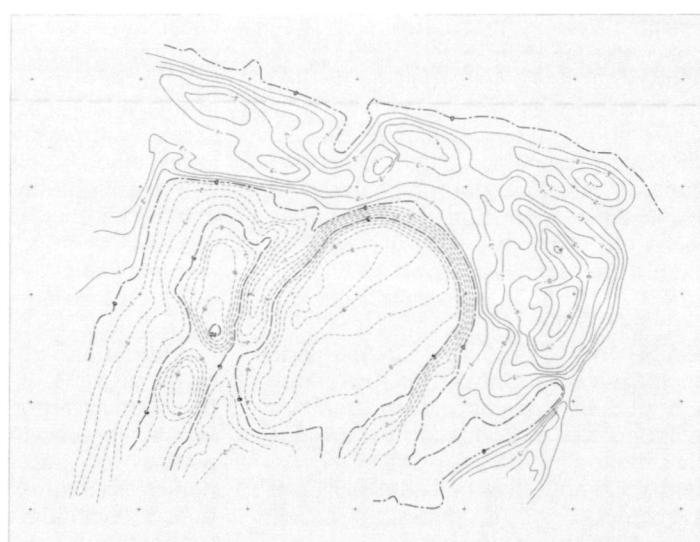
Abb. 4: Differenzmodell (DGM 3): Durchgezogene Linien: Schüttung; gestrichelte Linien: Abtrag; Äquidistanz: 1m.
