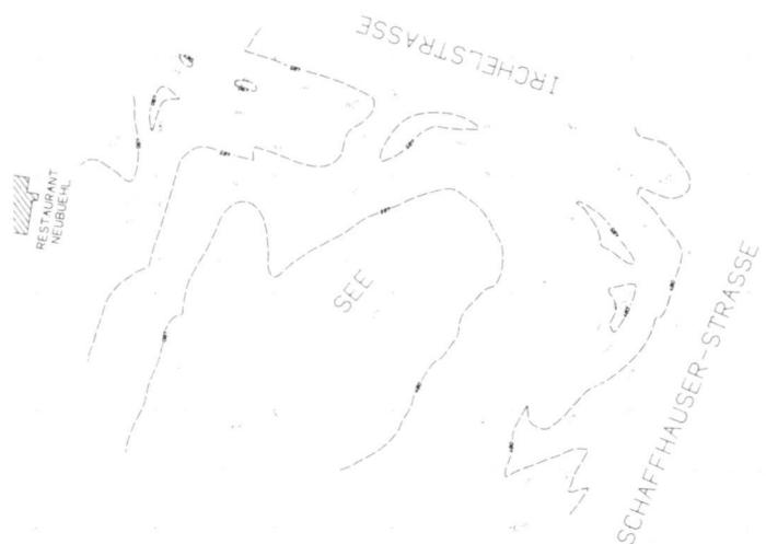
Abb. 3: Folgemessung (DGM 2): Topographische Aufnahme nach Abschluss der Erdbewegungsarbeiten. Äquidistanz: 1m.
