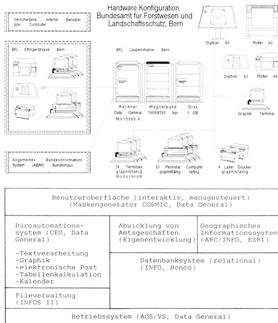
Abb. 2: Hardwarekonfiguration (oben) und Softwarekomponenten (unten) des Computersystems am BFL. Die graphischen Peripheriegeräte (rechts oben und links aussen) dienen der Digitalisierung, Bearbeitung und Ausgabe geographischer Daten (thematische Karten).
