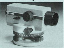
Beide Instrumente sind sogenannte «Automaten», bei denen die Ziellinie durch einen Kompensator automatisch horizontiert wird.
