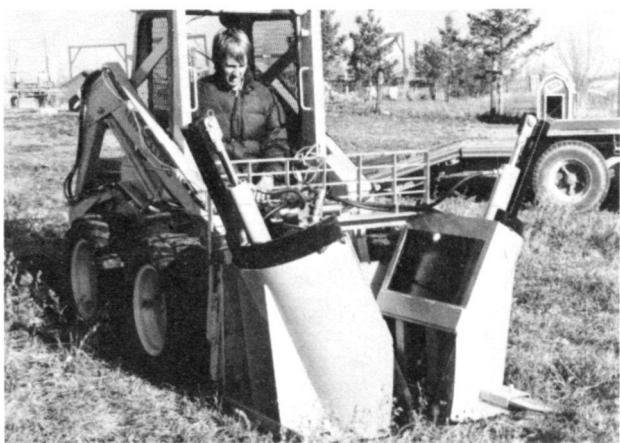
VERMEER-Baumverpflanzer in sieben Größen, für Bäume mit Ballendurchmessern von 50–215 cm. Als Anbaumodelle für Traktoren und Lader, als Anhängergeräte, als selbstfahrende Allradmaschinen mit vielen zusätzlichen Ausrüstungsmöglichkeiten wie Grabenfräsen, Tieflöffel, Lader und als Aufbaugeräte für Lastwagen.
