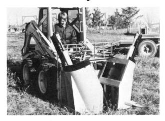
VERMEER-Baumverpflanzer in sieben Grössen, für Bäume mit Ballendurchmessern von 50–215 cm. Als Anbaumodelle für Traktoren und Lader, als Anhängergeräte, als selbstfahrende Allradmaschinen mit vielen zusätzlichen Ausrüstmöglichkeiten wie Grabenfräsen, Tieflöffel, Lader und als Aufbaugeräte für Lastwagen.
