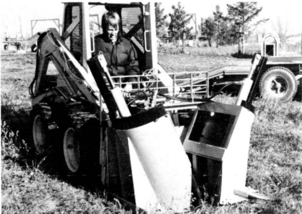
VERMEER-Baumverpflanzer in sieben Größen, für Bäume mit Ballendurchmessern von 50–215 cm. Als Anbaumodelle für Traktoren und Lader, als Anhängergeräte, als selbstfahrende Allradmaschinen mit vielen zusätzlichen Ausrüstmöglichkeiten wie Grabenfräsen, Tieflöffel, Lader und als Aufbaugeräte für Lastwagen.
