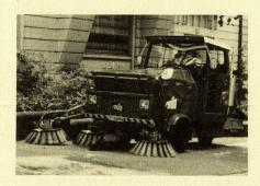
los von 0 bis 25 km/h regulierbar. Neu ist, dass das Fahrwerk vorne und hinten mit Gummiblökken gefedert ist. Die grossen 10-Zoll-Räder erlauben ein bequemes Auffahren auf Trottoirs und ruhiges Fahren auf unebenen oder gepflasterten Belägen. Die Maschine arbeitet ohne Staubbildung.
