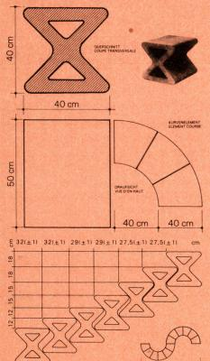
Mit Papillon-Elementen lassen sich Stufenhöhe und Stufentiefe gewissen Gegebenheiten anpassen oder innerhalb einer Treppe kontinuierlich verändern.
