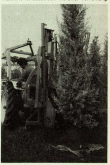
versehen, die verhindert, dass sich der Traktor in dem Moment abhebt, wenn die Spaten in die Erde stechen. Das Gerät kann auch zum Löchergraben beim Umpflanzen benutzt werden. (Mitteilung der Vertriebsfirma Silent AG, Dällikon/ZH)
