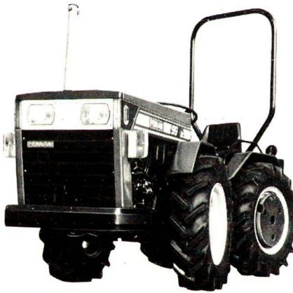
ferner aus durch grosse Steigfähigkeit und lassen sich mit verschiedenen Arbeitsgeräten kombinieren (Bodenbearbeitungsmaschinen usw.). Die Traktoren sind erhältlich mit 18-, 30-, 45- und 55-PS-Motoren. Generalvertrieb: Silent AG, Dällikon/ZH.
