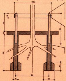
schrauben. Die Versetzarbeit ist unkompliziert. Die Metallteile sind schwer verformbar und brauchen keinen Unterhalt. Die Form ist platzsparend und funktionsgerecht.
