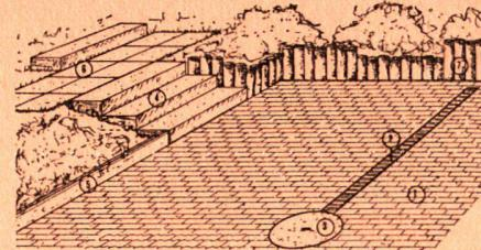
mit quadratischem Schachtrahmen für einfachere Belagsanschlüsse, 4 Blockstufen, 5 Stellriemen oder Stellsteine, 6 Gehwegplatten, 7 Palisadenhölzer, evtl. auch Betonrohre.
