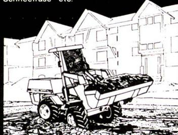
30 PS, hydrostatischer, stufenloser Allradantrieb - autom. Differentialsperre - hydr. Chassisnicklenkung - narrensicher, äußerst geländegängig, universell, preisgünstig!
