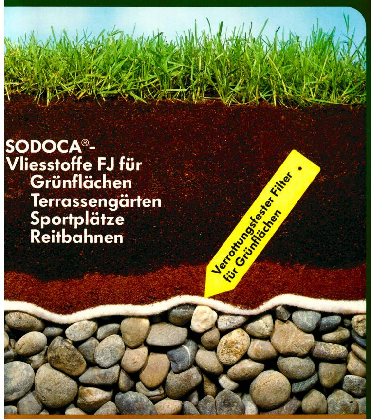
SODOCA FJ ist ein vollsynthetisches vernadeltes Endlosfaservlies aus isotaktischem Polypropylen, speziell als Trennfilter auf die Verwendung bei Terrassengärten abgestimmt. Dank ihrer Struktur verhindert die Trenn- und Filtermatte SODOCA FJ das Verschlammen der Drainageschicht durch Erde aus der oberen Lage.
