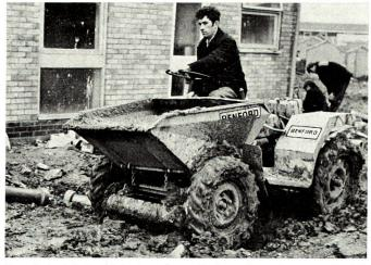
Zum Beispiel der kleinste universell einsetzbare Dumper, Modell DCP, mit 2-Rad-Antrieb, 7,5-PS 1-Zylinder Petter-Dieselmotor, mit mechanisch kippbarer Mulde, Inhalt 510 I, und einer Tragkraft von 1000 kg. Verlangen Sie eine unverbindliche Vorführung.
