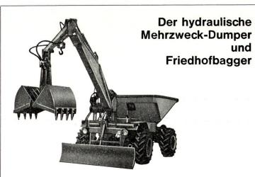
Mehrzweckdumper und Grabenbagger, 1000-1500 I Muldeninhalt, kipp- und drehbar in allen 3 Richtungen, Tragkraft 2700 kg. 7 verschiedene Löffeltypen von 20-60 cm Breite, Greifer nach Wunsch, hydr. verstellbares Planierschild, 6-Gang-Wendegetriebe.
