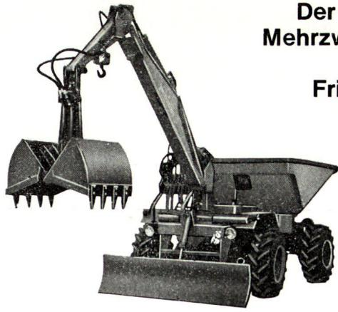
Mehrzweckdumper und Grabenbagger, 1000—1500 l Muldeninhalt, kipp- und drehbar in allen 3 Richtungen, Tragkraft 2700 kg, 7 verschiedene Löffeltypen von 20—60 cm Breite, Greifer nach Wunsch, hydr. verstellbares Planierschild, 6-Gang-Wendegetriebe.
