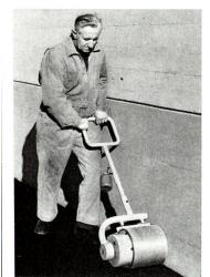
Lärmfrei und keine Abgase, ohne Motor Keine Wartung, problemlos Vibriert in einer Stossrichtung, verdichtet statisch in der anderen Verdichtung von Strassenbelägen jeder Art für Einsätze in Wohnquartieren, für Trottoirs, Gartengestaltung, Parkplätze. Flickarbeiten usw. Gewicht ca. 60 kg Walzenbreite 24 cm
