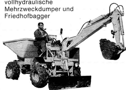
Mehrweckdumper und Grabenbagger, 1000-1500 l
