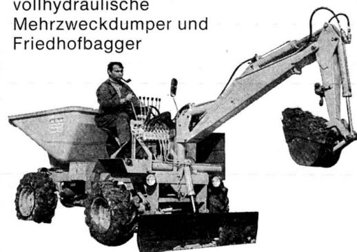
Mehrweckdumper und Grabenbagger, 1000-1500 l
