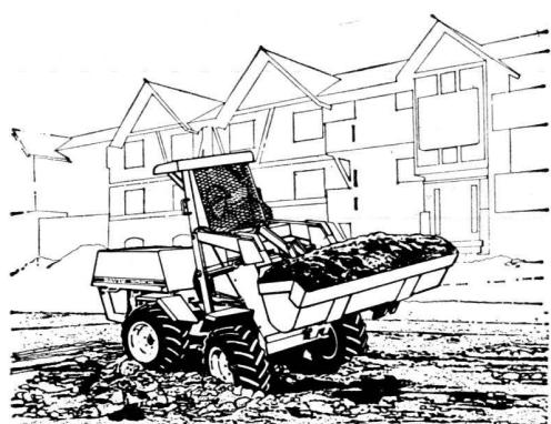
30 PS, hydrostatischer, stufenloser Allradantrieb —
