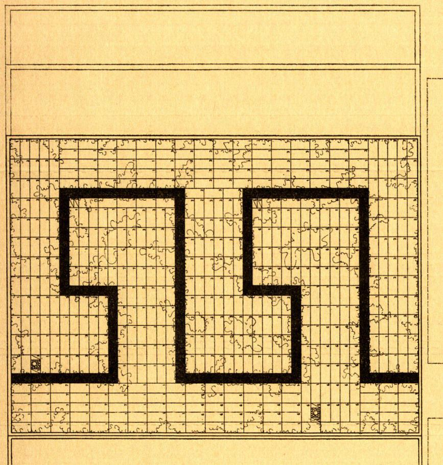
Die Planung und Ausführung von Dach-, Terrassen- und Balkongärten mit den Styroporbehältern des Systems «Mobiles Grün» ist denkbar einfach und narrensicher, da jede Pflanzenart bzw. jeder Behälter seine Nummer besitzt und nach Plan auch von Hilfsarbeitern zusammengestellt werden kann. Dank Staffelung und geometrisch verschiedenen möglichen Gruppierungen, ist bei aller Einfachheit eine grosse gestalterische Variationsbreite gegeben.
