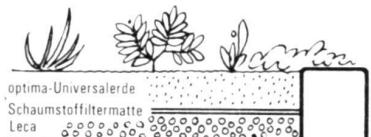
des Dachgartens. Die Elemente sind in Kürzester Zeit verlegt – der optima-Dachgarten kann u. U. schon in einem Tag fixfertig sein.
