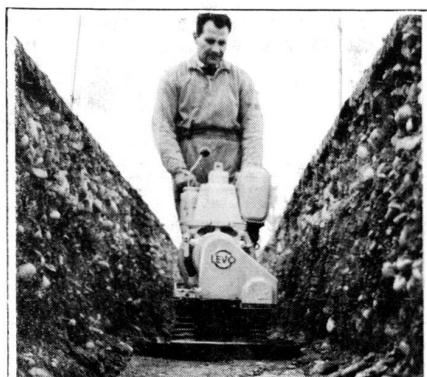
LEVO-Bodenverdichter mit der im Vor- und Rücklauf gleich hohen Verdichtungsleistung. Verschiedene Modelle für Arbeitsbreiten von 42–150 cm und einer Tiefenwirkung von 40–120 cm. Gewicht 245 kg–1150 kg.
