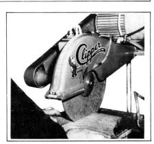
CLIPPER-Trennmaschinen schneiden Steine, Röhren, Beton, Eternit, Kunststoffe usw. rasch, präzis und staubfrei. Wir liefern CLIPPER-Maschinen für verschiedene Schnittlängen und -tiefen in stationärer und tragbarer Ausführung.
