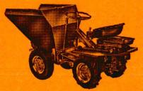
Le Bouyer T.52 à la fonction de pousseur et de tracteur à attelage instantané - Equipements multiples tels que benne, remorque, balayeuse, tondeuse etc. Moteur BERNARD W 239, 4 temps 6 vitesses avant, 3 vitesses arrière -Blocage du différentiel - En option centrale hydraulique 170 atm - NOU-VAUTE: benne à versement des 3 côtés.
