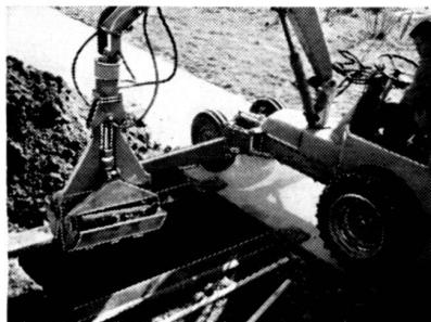
Der neue selbstfahrende Hydraulik-Schmalspur-Bagger für er Friedhofwege, der rationell, arbeitskräfteparend und schi Grabstätten aushebt. Eignet sich auch vorzüglich für die Dür führung von Erdbewegungsarbeiten, Aufladen von Erde, Schi usw., Grabenöffnungen für Drainagen usw. Er ist kipp- und standf auch mit Doppelbereifung lieferbar und ausserdem sehr preisw
