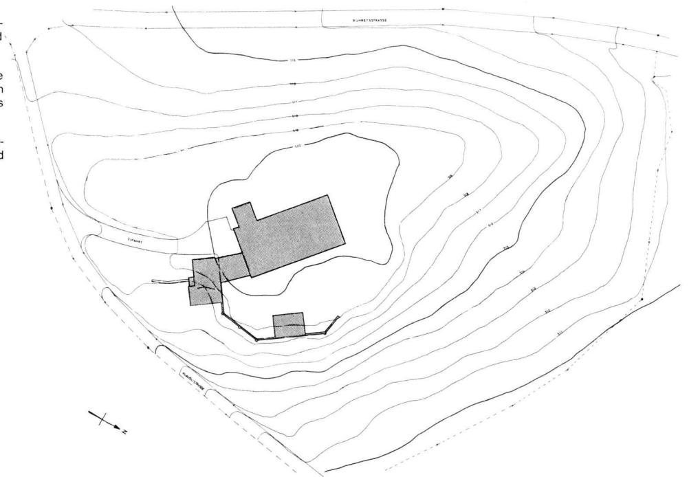
Seewasserwerk und Filterstation Thalwil-Rüschlikon. Neue Situation. Grossen Mengen von Auffüllmaterial sind hier zweckmässig für die Eindeckung des plumpen Ausgleichsreservoir-Kubus (Grundriss ohne Raster) und für eine bewegte und gefällige Gelände-Modellierung verwendet worden.
