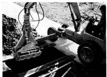
Der neue selbstfahrende Hydraulik-Schmalspur-Bagger für enge Friedhofwege, der rationell, arbeitskräftesparend und schnell Grabstätten aushebt. Eignet sich auch vorzüglich für die Durchführung von Erdbewegungsarbeiten, Aufladen von Erde, Schnee usw., Grabenöffnen für Drainagen usw. Er ist kipp- und standfest, auch mit Doppelbereifung lieferbar und ausserdem sehr preiswert.
