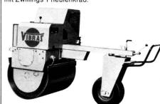
Doppel-Vibraswalze 1400 kg mit dem einzigartigen hydropneumatischen Lenksystem.
