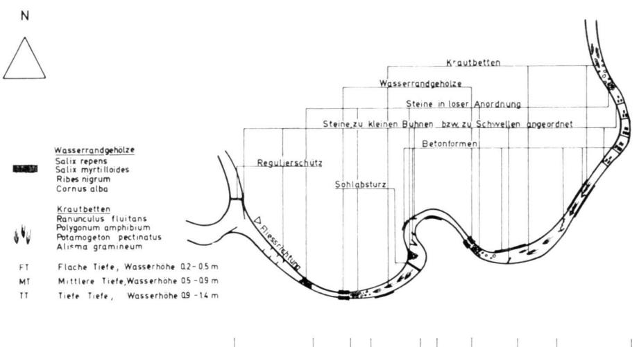
Cours d'eau avec indications concernant les plantes de rivage, les plantations d'herbacées, la disposition des pierres, les formes en béton. Direction du cours d'eau dans le plan de gauche à droite.
