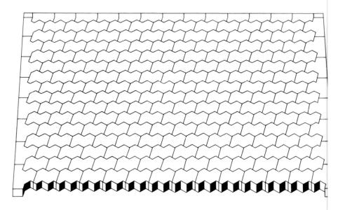
Die elastische Druckverteilung auf die umliegenden Steine entlastet den Unterbau ein gewichtiger Vorteil bei Meliorationswegen, Bushaltestellen, Garageeinfahrte und befahrbaren Vorplätzen.
