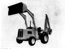
**DYNAHOE,** Pneubagger und -Lader Vollhydraulisch, mit Powershift-Getriebe, Tieflöffel bis ca. 5 m (mit Greifer entsprechend tiefer); auch als Hebezeug verwendbar bis 2,5 t (voll ausgestreckt), Ladeschaufel 1,5 m³, Reisskraft 5,6 t, Hubkraft 2,2 t, Tragkraft 3,3 t, 89 PS. Ab Fr. 80 000.—.
