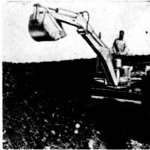
**DAVIS-TRENCHER:** 9 Modelle. Grabbreiten: 5—70 cm, Grabtiefen: bis 230 cm, Grabgeschwindigkeit: bis 540 m/h. Preise: Fr. 5200.— bis etwa Fr. 145 000.—. Zubehör: Tieflöffel, Dozer, Lader, Bohrgerät, Kabelverleger-Maschinen usw.
