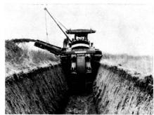
**CLEVELAND-TRENCHER:** 13 Modelle + 2 Backfiller und Tamper. Grabbreiten: 25 cm bis 1,5 m (verstellbares Rad bis 1,8 m, Krone bis 6 m breit). Grabgeschwindigkeit bis 44 m/min. Preise: ab Fr. 79 000.— bis etwa Fr. 490 000.—.
