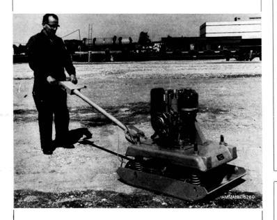
Der 5A ist ein leistungsfähiger Bodenverdichter mit zahlreichen Anwendungsmöglichkeiten. Hier einige Einsatzbeispiele: Zum Verdichten aller körnigen Bodenarten, wie Sand- und Kiesböden im Erdbau. Für bindige Böden in trockenem Zustand. Zum Verdichten von Rohrleitungs- und Kabelgräben. - Aber auch dem Gartenbauer leistet dieser Bodenverdichter ausgezeichnete Dienste! Und das Wichtigste: Der AMMANN Bodenverdichter 5A ist sehr preisgünstig. - Ueberzeugen Sie sich selbst:
