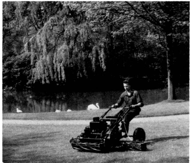
**LAWN MAKER** Rasenbaumaschinen bearbeiten das Saatbeet, düngen und säen in einem Arbeitsgang
