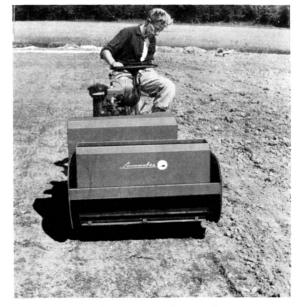
Es ist erstaunlich, in welch kurzer Zeit hier eine Spielwiese vorbereitet, gedüngt und angesät wurde. Nach der aufgeführten Rohplanie wurde die grobe und zähe Erde mit dem Lawnmaker bearbeitet, die Fläche abgeschnürt, Unebenheiten ausgeglichen und anschliessend im gleichen Arbeitsgang gedüngt und 15 g/m² angesät. Trotz sehr trockener Witterung erfolgte der Graswuchs gleichmässig und dicht.
