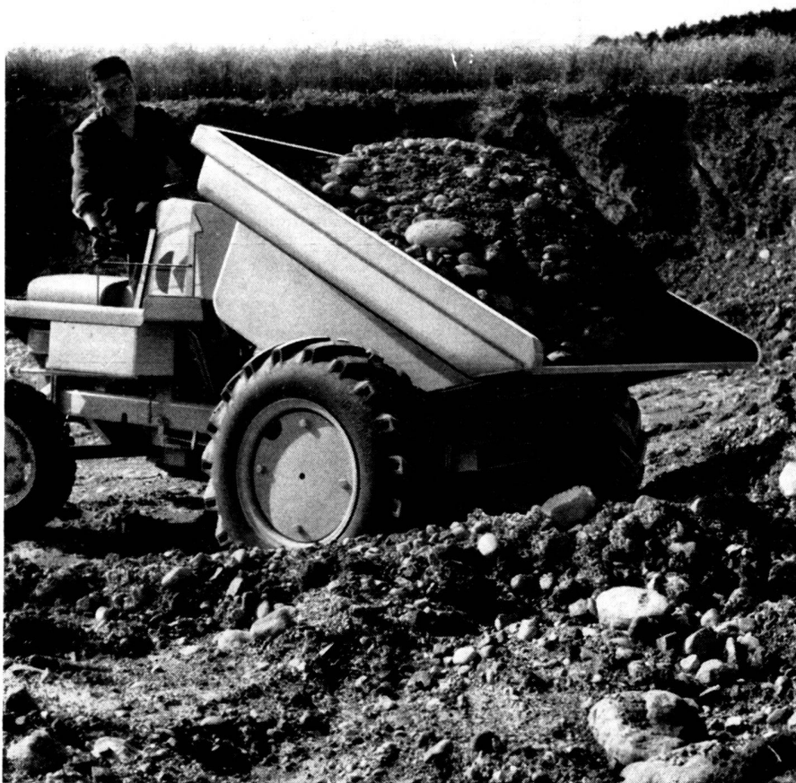
Der CK Dumper ist auch mit Brücke lieferbar (für 2 Betonkübel à 0,5 m 3 )
