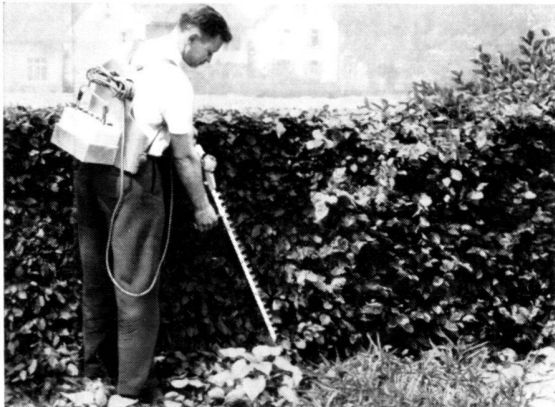
Motorheckenschneider «Little Wonder» mit Batterieantrieb ist vollkommen geräuschlos und unabhängig von Stromanschlüssen oder Aggregaten.
