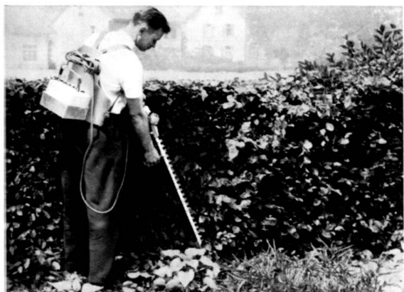
Motorheckenschneider «Little Wonder» mit Batterieantrieb ist vollkommen geräuschlos und unabhängig von Stromanschlüssen oder Aggregaten.
