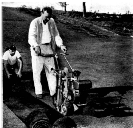
Die Ryan-Rasenziegelschneider gehören zu den grössten Errungenschaften auf diesem Gebiete. Bis zu 2000 lfm Rollrasen pro Stunde.
