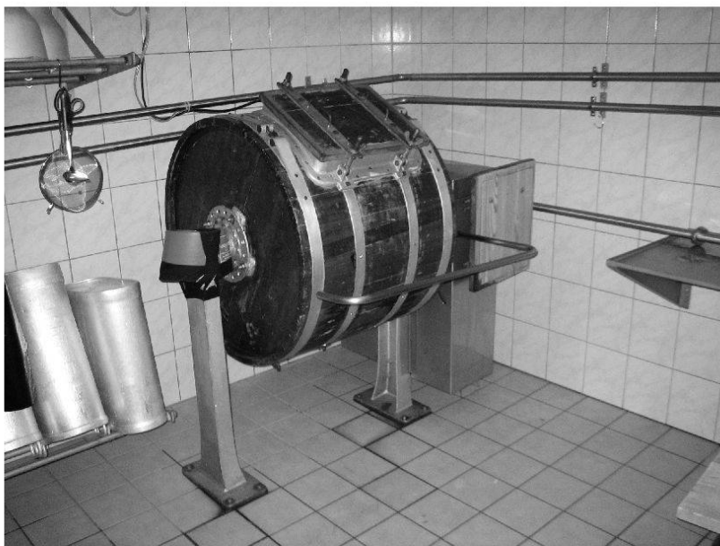
La panaglia da mola cun motor d'electricitad. La panaglia ei fermada giun plaun damai che la panaglia generescha vibraziuns.
