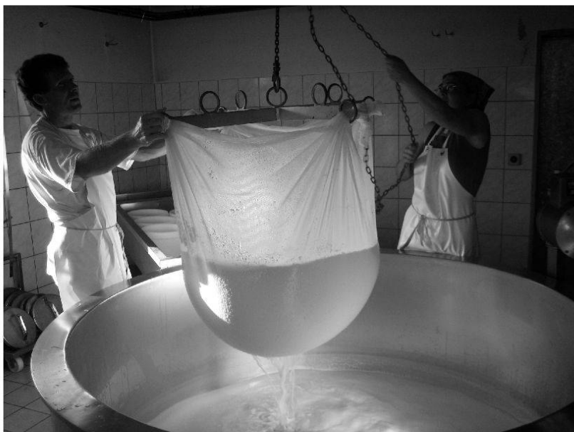
Il stratsch vegn fermaus vid ina cruscha da metal ed alzaus ora cun ina schirella.
