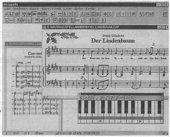
Der capella-Bildschirm mit zwei Partituren in unterschiedlicher Darstellung und dem sogenannten «Mausklavier».
