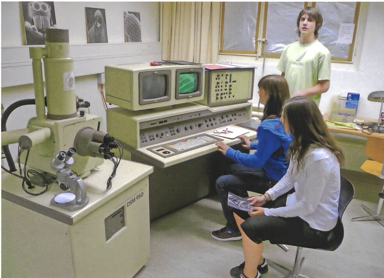
Abb. 3: Im Jahr 2007 wurde der NKSA ein neues REM (Zeiss DSM-950) angeboten, mit dem bereits digitale Aufnahmen gemacht werden konnten. Anfang 2008 wurde das fast 40 Jahre alte Stereoscan -REM durch das digitale Zeiss -REM ersetzt. Kurz nach der ersten Inbetriebnahme konnte es bereits für den Unterricht eingesetzt werden.
