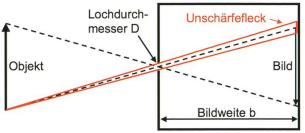
**Abb. 2:** Lochkamera mit Unschärfefleck für grosses Loch mit vernachlässigbaren Interferenzeffekten. Ist das Objekt weit entfernt, wird der Unschärfefleck gleich der Lochgrösse. Bild: Fritz Gassmann
