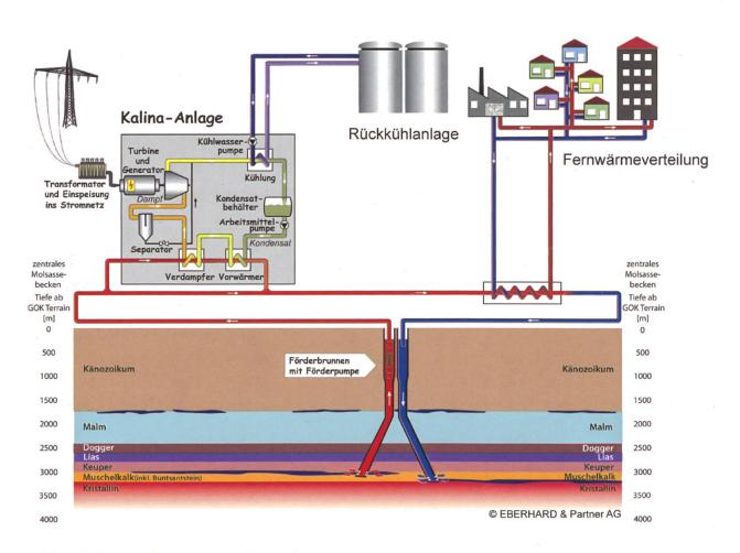
Abb. 23: Prinzipschema einer Kalina-Anlage
