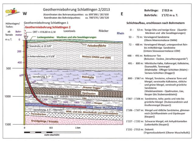
Abb. 15: Querschnitt durch den abgelenkten Förderbrunnen in Schlattingen (TG) / Quelle: [12]
