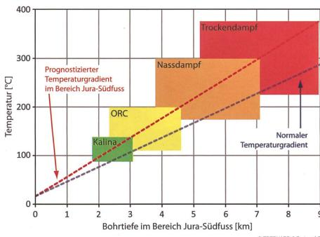
**Abb. 22:** Anlagetypen der geothermischen Kraftwerke
