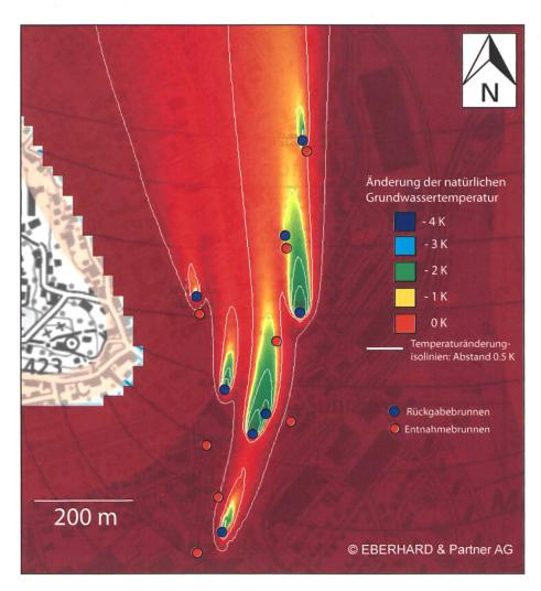
**Abb. 29:** Grundwasser-Modflow-Modellierung im Bereich Suhr (AG)
