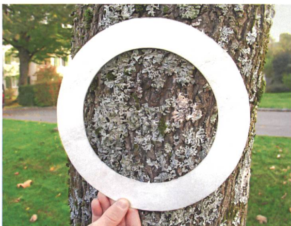
Abb. 7: Stichprobenring aus Karton, Innendurchmesser = 18 cm (WEBER 1991).
