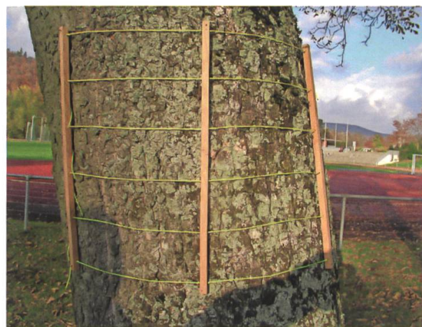
Abb. 8: Flechtenzählrahmen mit 10 Feldern, deren Flächen je 300 cm 2 betragen (nach WEBER 1991).
