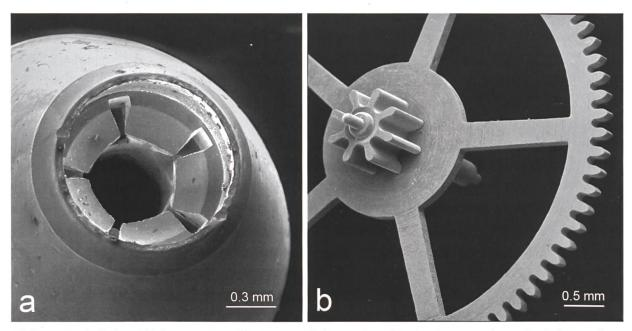
**Abb. 4:** Technische Objekte aus Metall eignen sich besonders für eine Untersuchung im REM, weil sie nicht mit Gold bedampft werden müssen. a) Spitze eines Kugelschreibers, bei der die Schreibkugel entfernt wurde, um die zuführenden Tintenkanäle zu zeigen. b) Zahnrädchen aus einer Armbanduhr, welches die Präzision in der mechanischen Fertigung deutlich macht.
