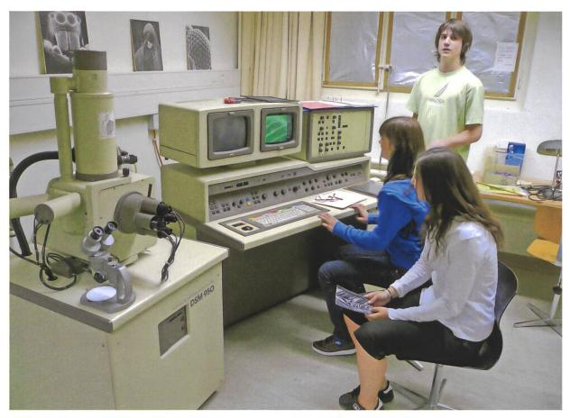
**Abb. 3:** Im Jahr 2007 wurde der NKSA ein neueres REM (Zeiss DSM-950) angeboten, mit dem bereits digitale Aufnahmen gemacht werden konnten. Anfang 2008 wurde das fast 40 Jahre alte *Stereoscan*-REM durch das digitale *Zeiss*-REM ersetzt. Kurz nach der ersten Inbetriebnahme konnte es bereits für den Unterricht eingesetzt werden.
