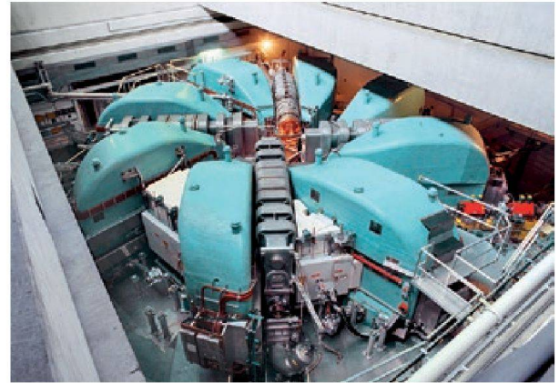
Abb. 8: Das historische Herzstück der Grossanlagenforschung am PSI: Der Protonen-Ringbeschleuniger. 8 Ablenkmagnete (blaugrün) halten die Protonen auf einer spiralförmigen Bahn. Die 4 Kavitäten (grau) beschleunigen die Protonen. Bild: PSI.
