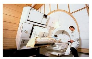
Abb. 14a: Die 1996 in Betrieb genommene Gantry-1 war die erste Protonengantry Europas zur Bestrahlung tief liegender Tumoren, die den Strahl um 360° drehen kann.
