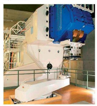
Abb. 14b: Die 2012 in Betrieb gehende neue Gantry-2 kann den Strahl in zwei Richtungen ablenken und erfüllt so die Voraussetzung für die Bestrahlung von Turmoren, die beispielsweise bei der Atmung des Patienten die Lage verändern. Bilder: PSI.
