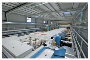
Abb. 39: 60 m lange Testanlage für die erste Beschleunigungsstufe des SwissFEL: Die ersten 20 cm sind entscheidend für die Qualität der 700 m langen Gesamtanlage. Bild: PSI.
