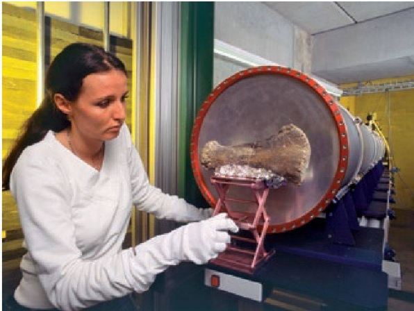
Abb. 26 a: Ein Dinosaurierknochen wird mit Hilfe von Neutronen durchleuchtet. Bild: Bramaz, PSI.
