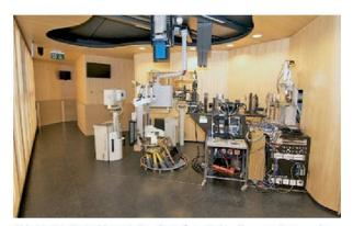
Abb. 11: Die Bestrahlungsstation Optis-2 zur Behandlung von Augenmelanomen mit Protonen (Inbetriebnahme 2010). Bild: PSI.
