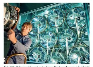
Abb. 19b: Solarsimulator mit zehn Xenon-Kurzbogenlampen à je 15 kW für wetterunabhängige Untersuchungen. Im Fokus wird damit eine Leistungsdichte von 1 kW pro cm² erreicht, die doppelt so hoch ist wie beim Solarofen. Bilder: PSI.
