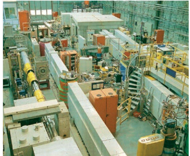
Abb. 25: Neutronen-Experimentierhalle. Deutlich sichtbar sind die langen Neutronenleiter, die mit Hilfe von speziellen Spiegeln die Neutronen von der Quelle SINQ zu den Experimenten (im Hintergrund) leiten. Bild: PSI.
