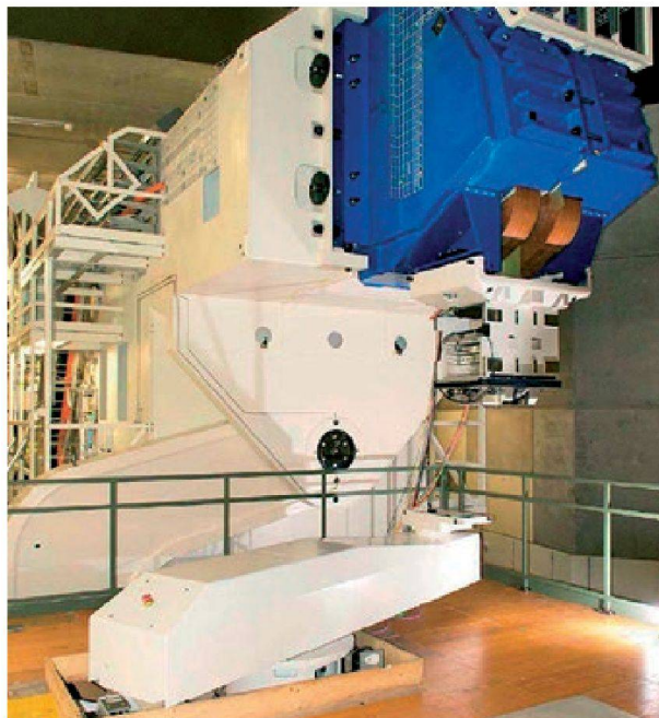
Abb. 14b: Die 2012 in Betrieb gehende neue Gantry-2 kann den Strahl in zwei Richtungen ablenken und erfüllt so die Voraussetzung für die Bestrahlung von Tumoren, die beispielsweise bei der Atmung des Patienten die Lage verändern. Bilder: PSI.
