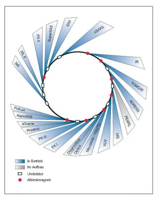
Abb. 7: Die Experimentierplätze (18 Strahllinien, Stand Jan. 2011) der SLS sind tangential zum Speicherring angeordnet und werden für folgende Themen benutzt:
