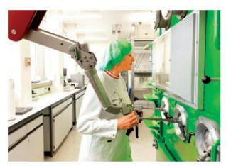
Abb. 34: Eine Laborantin steuert mittels eines Manipulators die Abläufe im Inneren einer mit Blei abgeschirmten Kammer, in der das radioaktive Medikament <sup>90</sup>Y-Zevalin® hergestellt wird. Bild: PSI.
