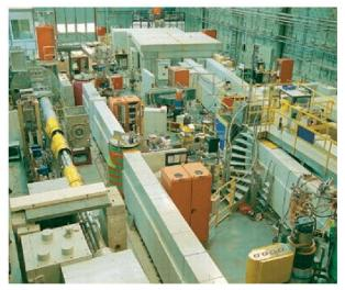
Abb. 25: Neutronen-Experimentierhalle. Deutlich sichtbar sind die langen Neutronenleiter, die mit Hilfe von speziellen Spiegeln die Neutronen von der Quelle SINQ zu den Experimenten (im Hintergrund) leiten. Bild: PSI.
