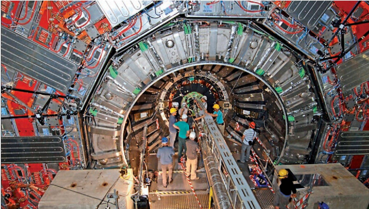
Abb. 29: Einbau des am PSI entwickelten Barrel-Pixel-Detektors in den riesigen CMS-Detektor des CERN im August 2008. Bild: Bramaz.
