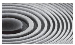
Abb. 36: Master-Struktur eines nano-optischen Elementes (Fresnel'sche Zonenplatte). Die Breite der äussersten Gräben beträgt 40 nm. Zum Vergleich: Die Wellenlänge von rotem Licht ist 600 nm. Bild: PSI.
