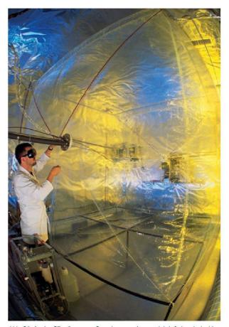
Abb. 24: In der 27 m³ grossen Smogkammer lassen sich luftchemische Vorgänge unter kontrollierten Bedingungen beobachten. Bild: PSI.
