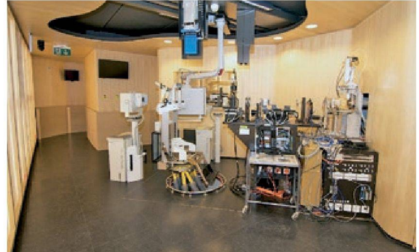
Abb. 11: Die Bestrahlungsstation Optis-2 zur Behandlung von Augenmelanomen mit Protonen (Inbetriebnahme 2010). Bild: PSI.
