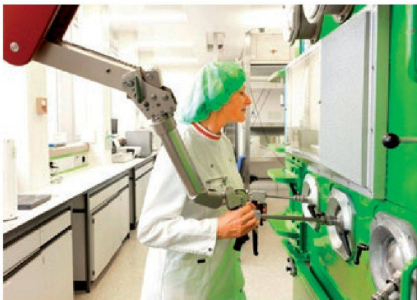
Abb. 34: Eine Laborantin steuert mittels eines Manipulators die Abläufe im Inneren einer mit Blei abgeschirmten Kammer, in der das radioaktive Medikament 90 Y-Zevalin® hergestellt wird. Bild: PSI.
