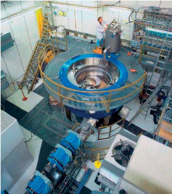
Abb. 13: Das am PSI entwickelte neue supraleitende Protonen-Zyklotron COMET ist die kompakteste derartige Maschine weltweit. Im unteren Bildteil erkennt man die Komponenten, die den extrahierten Strahl zu den Bestrahlungsstationen leiten. Bild: PSI.
