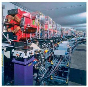
Abb. 5: Rund 350 Magnete zwingen die Elektronen im 300 m langen Speicherring der SLS auf eine Kreisbahn und sorgen dafür, dass die Elektronenpakete möglichst klein bleiben. Foto: PSI.
