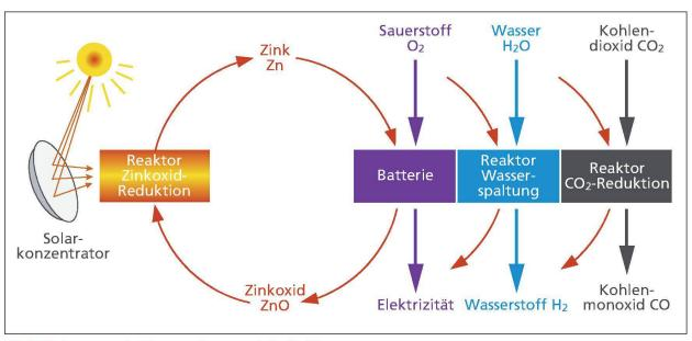
Abb. 20: Kreisprozesse zur Speicherung von Sonnenenergie. Grafik: PSI.
