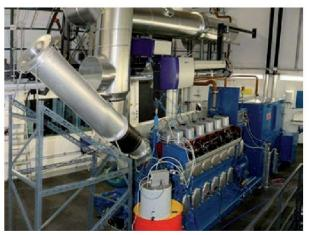
Abb. 23: Teststand mit einem 6-Zylinder Dieselmotor von 1.1 MW Leistung für die Überprüfung von Konzepten zur Reduktion von Emissionen. Bild: PSI.
