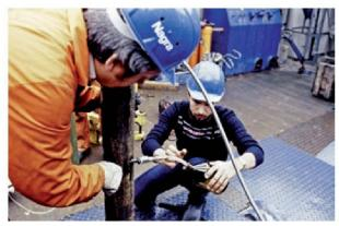
Abb. 11: Probenahme von Thermalwasser aus einer Nagra-Bohrung
