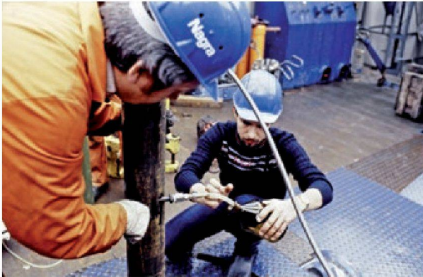
Abb. 11: Probenahme von Thermalwasser aus einer Nagra-Bohrung
