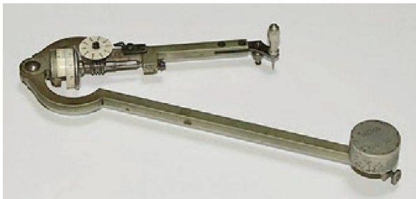
Abb. 22: Amsler Polarplanimeter zur Flächenmessung auf Plänen http://de.wikipedia.org/w/index.php?title=Datei:Amsler-Polarplanimeter-2.jpg&filetimestamp=20101108014100
