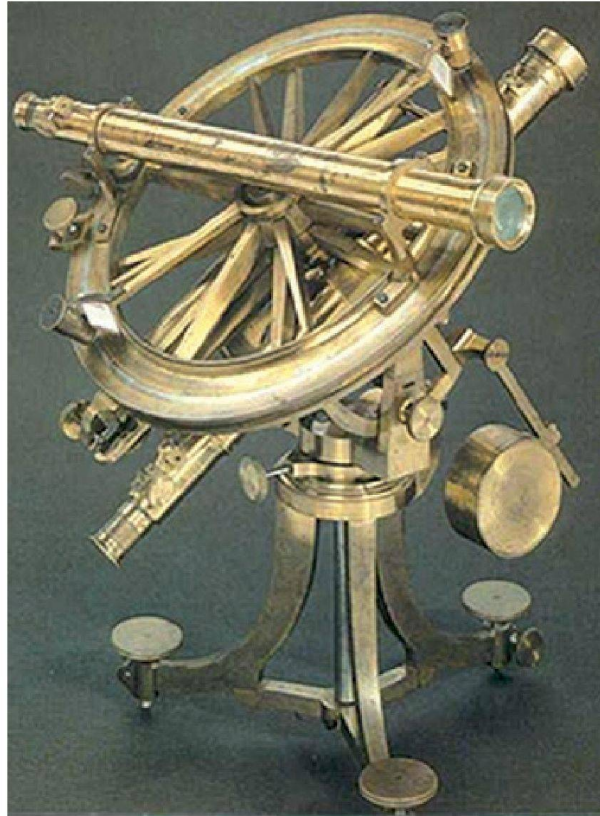
Abb. 36: Mit diesem Theodolit der Firma Kern Aarau führte General Dufour 1835 die erste Triangulation in der Schweiz durch. www.familymueller.ch/Renes/Leica/Bilder/Theodolit_Dufour.jpg
