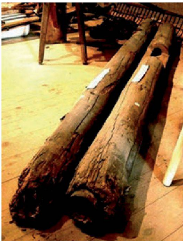
Abb. 10. Wasserdeichel (Dünkel) mit Röhrenbüchsen zur wasserdichten Verbindung, Ortsmuseum Unterenfelden (Staufferhaus) http://www.wirrizunft.ch/pages/Bachgeschichte.htm
