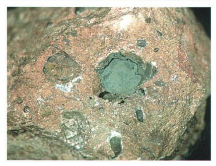
**Abb. 40:** 'Blauerde' als Belag auf den Erzbohnen und zusammen mit Ton als kleine, blaue Körner im Kalkspat der Kalkknollen. (3,5x) Foto: J. Källn.
