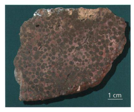
**Abb. 10:** Die vielen Erzbohnen in diesem aufgeschnittenen Stück Bohnerz hätten einen Abbau gelohnt. Foto: W. SCHILL.
