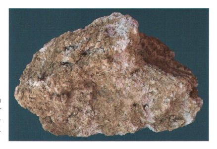
**Abb. 6:** Aus dem Vorkommen Lindgraben Ost stammt dieser stark limonit- und hämatitgefärbte Boluston. Foto: W. SCHILL.
