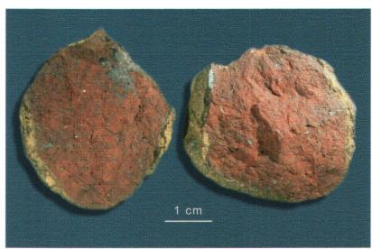
**Abb. 34:** Diese hämatitreiche Erzbohne ist mit einer Limonit-kruste überzogen. (1,5x) Foto: J. KÄLIN.
