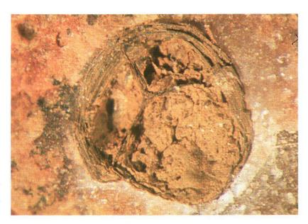
**Abb. 29:** Limonitische Tongalle mit einer Umrandung von Kalkspat. Die Tonhäute sind stark verfaltet. (20x) Foto: J. KÄLIN.
