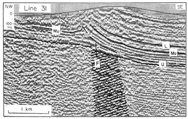
Fig. 3: Reflexionsseismisches Profil 83-NF-31 durch die Mandacher Struktur (aus LAUBSCHER 1986a). Deutlich zu erkennen ist die Überlagerung der Nordbegrenzung des spätpaläozoischen Frick-Konstanz-Troges (schraffiert), der oligozänen Mandacher Flexur und der miozänen Mandacher Überschiebung.
