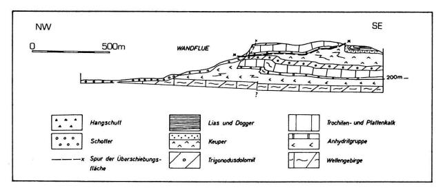
Fig. 5: Profil durch die Mettauer Überschiebung an der Wandfluh (westlich Leibstadt, aus WILDI 1975). Charakteristisch ist die scharfe, südvergente Überschiebung des Muschelkalkbrettes und die tektonisch bedingte Anhäufung der Anhydritgruppe (Mittlere Trias).
