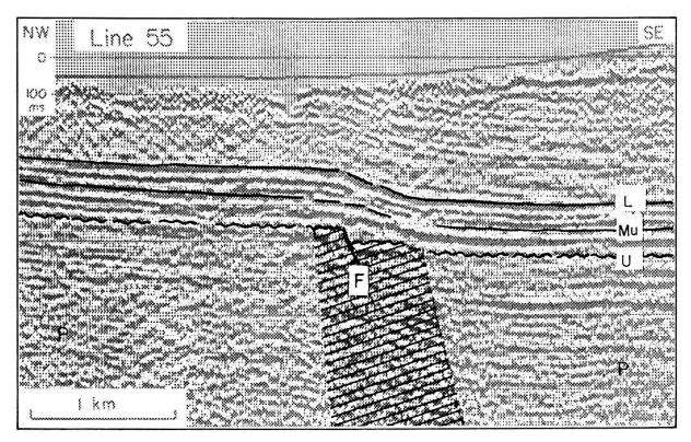
Fig. 6: Reflexionsseismisches Profil 83-NF-55 durch die Rekinger Flexur (aus LAUBSCHER 1986a). Deutlich zum Ausdruck kommt die Rekinger Flexur über der Nordbegrenzung des Frick-Konstanz-Troges (schraffiert). Knapp zu erahnen ist die Abschiebung von Tegerfelden im obersten Teil der Flexur.
