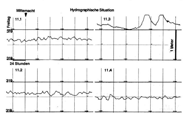
Abb. 11: Pegelstandschwankungen oberhalb der Brücke Kleindöttingen während einer Woche, in Abhängigkeit des Wasserstandes. Die Aufzeichnung beginnt am Freitagnachmittag. Die vertikalen Zeitlinien geben 24.00 Uhr an. Die untere, horizontale Niveaulinie bezeichnet den Pegel 318,00 m ü. M., die obere 319,00 m ü. M.
