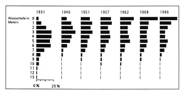
Abb. 8: Tiefenverteilung des Klingnauer Stausees 1931 bis 1986. Die Zellen der Tiefenmodelle wurden auf einen Meter Genauigkeit gerundet und die Frequenz gegen die Tiefenklasse aufgetragen. Nur die Zellen innerhalb der Dämme wurden verwendet.
