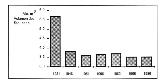
Abb. 7: Volumenabnahme des Klingnauer Stausees von 1935 bis 1986, berechnet aus den Querprofilaufnahmen des Kraftwerks Klingnau. Rund 2 Mio Kubikmeter Sand und Schlick wurden von der Aare in der linken Seebucht deponiert, während der Hauptlauf seine Form nur wenig veränderte. Die Abbildung zeigt das Gesamtvolumen des Stausees, Hauptlauf und Seebucht zusammen.
