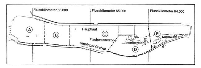
Abb. 9: Gliederung des Klingnauer Stausees. Das Kraftwerk benutzt für die Vermessung eine Hektometrierung: Entlang dem Flussufer sind alle 100 m Markiersteine gesetzt. Der Stausee beginnt kurz vor der Kilometermarke 63.300 und endet nach der Kilometermarke 66.300.
